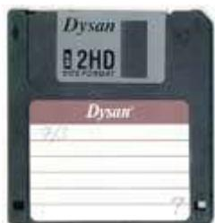
Disketa, poznata pod imenom Floppy disk, je uređaj za spremanje podataka koji se sastoji od savitljive tanke okrugle pločice presvučene tankim slojem magnetskog materijala koja se nalazi unutar plastične omotnice kvadratnog oblika. Disketa ima dviye magnetske glave koje prianjaju uz obje površine rotirajuće diskete. Prosječno treba 1/6 sekunde za pomicanje magnetske glave na bilo koje mjesto na disketi.
