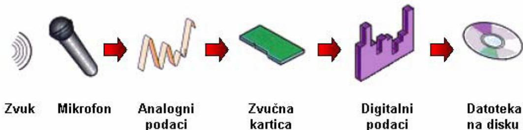
Ključni korak u ovom postupku pretvorba je analognog električnog signala u digitalni oblik. Analogno-digitalni (AD) pretvornik u zvučnoj kartici mjeri ulazni električni signal i dobivene vrijednosti zapisuje kao niz brojeva tj. **uzoraka**. Niz uzoraka tvori **digitalni zapis zvuka**.
